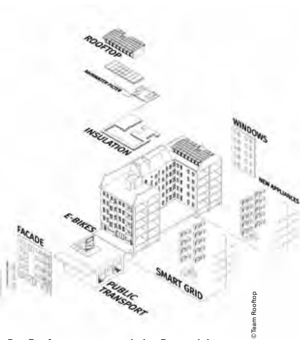
Das Rooftop versorgt auch den Bestand darunter mit Energie und ist so in die neue energetische Infrastruktur mit eingebunden
